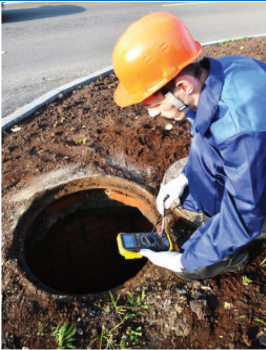
Рисунок 6. Техническое диагностирование Лаборатории неразрушающего контроля и диагностики: а - замеры потенциала блуждающих токов; б – толщинометрия.
