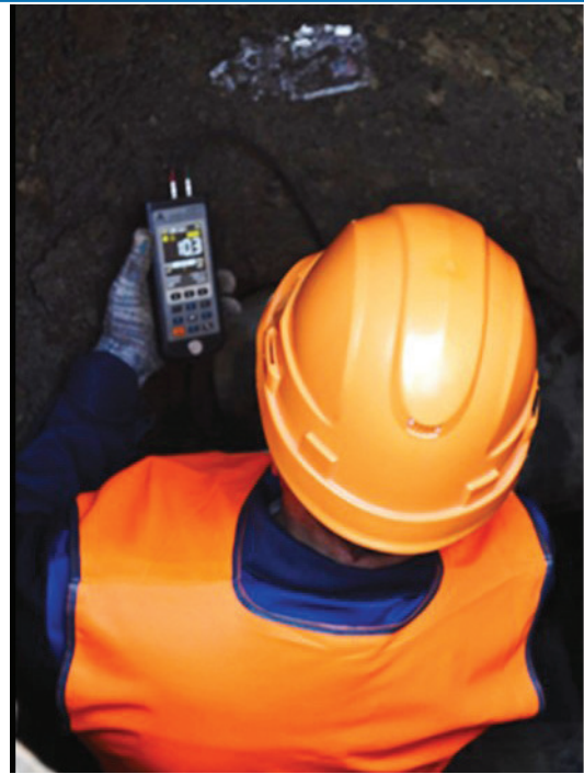
Рисунок 6. Техническое диагностирование Лаборатории неразрушающего контроля и диагностики: а - замеры потенциала блуждающих токов; б – толщинометрия.
