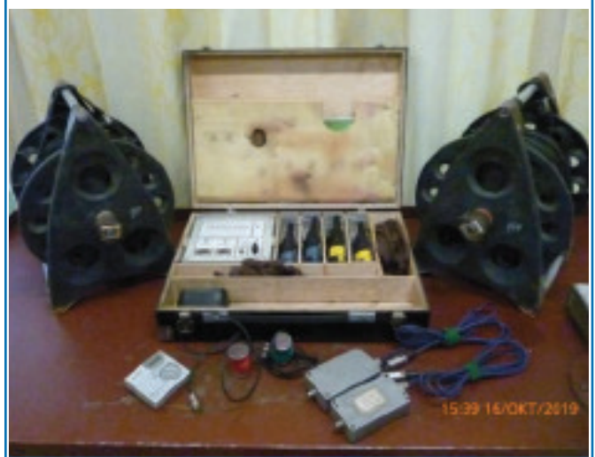
Рисунок 7. Инженерная диагностика труб с помощью течеискателя.
