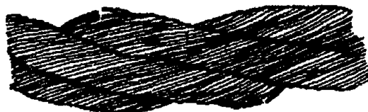
Рисунок 1. Обрывы и смещения проволок каната крестовой свивки
