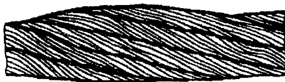
Рисунок 13. Местное увеличение диаметра каната
